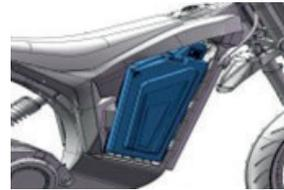
4. Connectez l'extrémité de sortie du chargeur au port de charge de la batterie au lithium et l'autre extrémité à la source d'alimentation.
