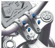
2. Fixez successivement le levier de frein arrière, l'interrupteur combiné et la poignée sur le guidon.
