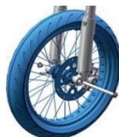
6. Vissez l'axe de la roue avant dans la position de montage de la roue avant sur la fourche avant et serrez les 4 boulons.
