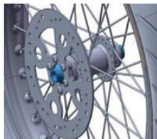
4. Retirez les 4 boulons et retirez l'axe de la roue avant.
